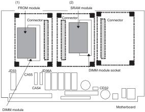
DIMM module socket
